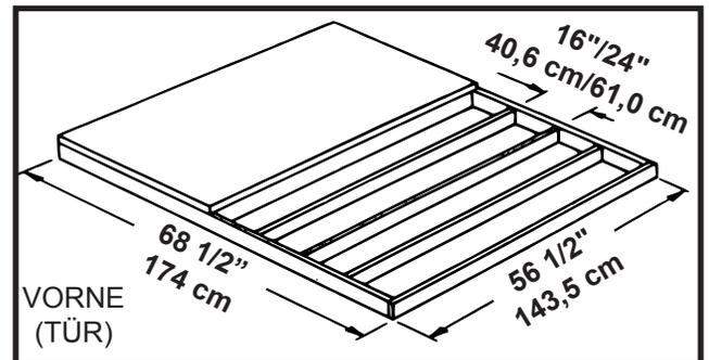
Hinweis: Die Plattform/Bodenplatte ragt auf allen vier Seiten 1,4 cm aus dem Bodenrahmen heraus. Versiegeln Sie diese 1,4 cm Holz mit einem Dachkleber (nicht im Lieferumfang enthalten) oder schrägen Sie diese 1,4 cm Beton beim Gießen für eine gute Drainage ab.
