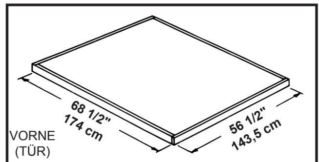
Hinweis: Abmessungen der fertigen Bodenplatte nach Entfernen der Verschalung.
